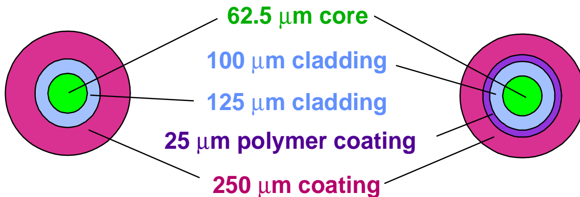
Slika 6. Struktura VOLITION™ optičkih kabela sa povećanom fleksibilnosti
